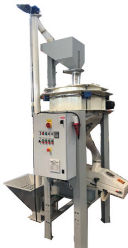
Il prodotto entra per gravità in una coclea dosatrice nel sistema di decorticazione, dove viene sgusciato tramite un'azione centrifuga. Successivamente, il prodotto passa attraverso un cestello forato che cambia in funzione della tipologia di prodotto da trattare, uscendo poi dall'unità di decorticazione. Il sistema di aspirazione all'uscita separa la parte leggera (glume) dal chicco, il quale viene inviato in un sistema di separazione oscillante.
